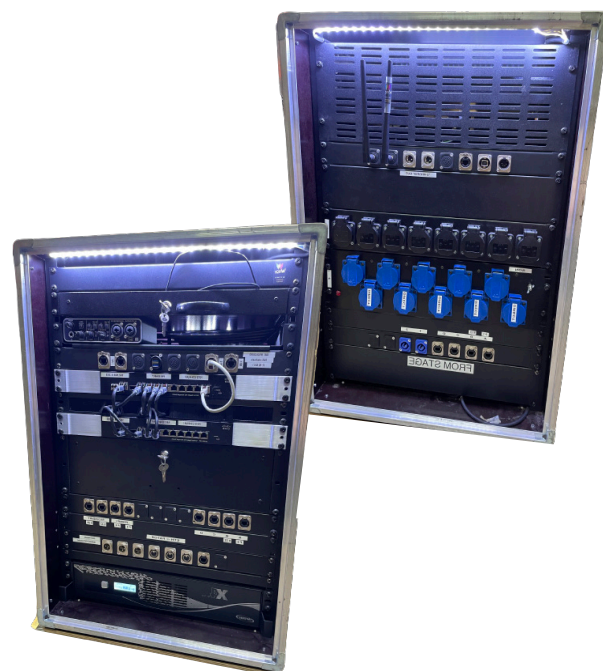
RACK STAGE 2 switch SG310 / Alim 63A vers 2 x 32A Splitter AES / onduleur
